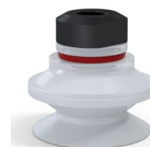
Riferimento variante: 91 31SLT 18D-2-F • Colore: Trasparente Certificato alimentare CE • Durezza Shore: SH 60 • Materiale: Silicone
