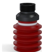
Référence déclinaison : 92 30SL 38D-2-F • Couleur: Rouge certification alimentaire CE • Dureté Shore: SH60 • Matière: Silicone
