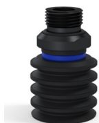
Référence déclinaison : 92 30NI 38D-2-F • Couleur: Noir • Dureté Shore: SH70 • Matière: Nitrile
