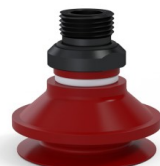
Référence déclinaison : 91 40SL 38D-2-F • Couleur: Rouge certification alimentaire CE • Dureté Shore: SH60 • Matière: Silicone
