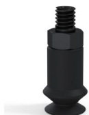
Référence déclinaison : 91 10NI M5M • Couleur: Noir • Dureté Shore: SH50 • Matière: Nitrile
