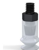
Référence déclinaison : 91 10SLT M5M • Couleur: Translucide certification alimentaire CE • Dureté Shore: SH60 • Matière: Silicone
