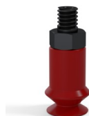
Référence déclinaison : 91 10SL M5M • Couleur: Rouge certification alimentaire CE • Dureté Shore: SH60 • Matière: Silicone
