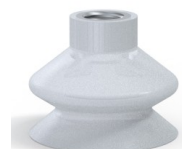
Référence déclinaison : 8A 44SLT F14 • Couleur: Translucide certification alimentaire CE • Dureté Shore: SH60 • Matière: Silicone
