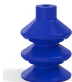
Référence déclinaison : 8M 25SLBLEU A • Couleur: Bleu • Dureté Shore: SH60 • Matière: Silicone
