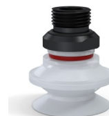
Referencia de la variante: 91 31SLT 38D-2-GIC • Color: Translúcido certificación alimentaria CE • Dureza Shore: SH60 • Materiales: Silicona
